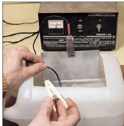
**4** Branchez, le dégagement de bulles est instantané. Si rien ne se passe, vérifiez les contacts. Ajustez l'intensité en jouant sur la distance entre la tôle et la pièce. Une surcharge abîmerait le chargeur.
