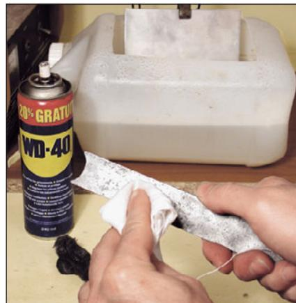
**6** Le résidu noir s'élimine aisément par brossage à la laine d'acier. La pièce n'étant pas à l'abri d'une réoxydation, une protection antirouille de type WD40, voire une simple couche d'encaustique, suffit.
